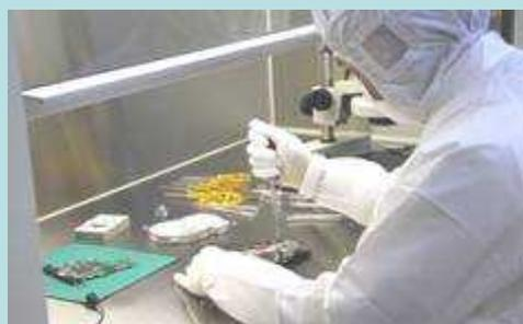
クリーンルームでのハードディスク開封作業の様子。データ復元の為に残留磁気情報の抽出を行う。
